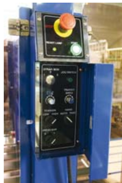
L'écran synoptique est bien dissimulé derrière un couvercle de protection. La sélection du nombre de cerclages, de la tension, la commande de la presse, ...
