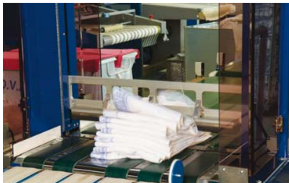
Grâce au plateau-presseur, la pile de linge est bien comprimée avant le cerclage. Le paquet est ensuite cerclé deux fois.
