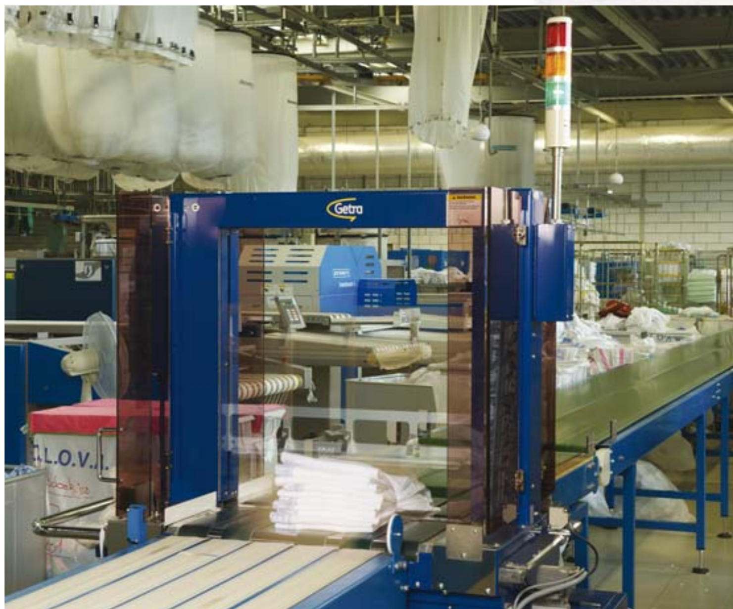
Grâce au plateau-presseur, la pile de linge est bien comprimée avant le cerclage. Le paquet est ensuite cerclé deux fois.
