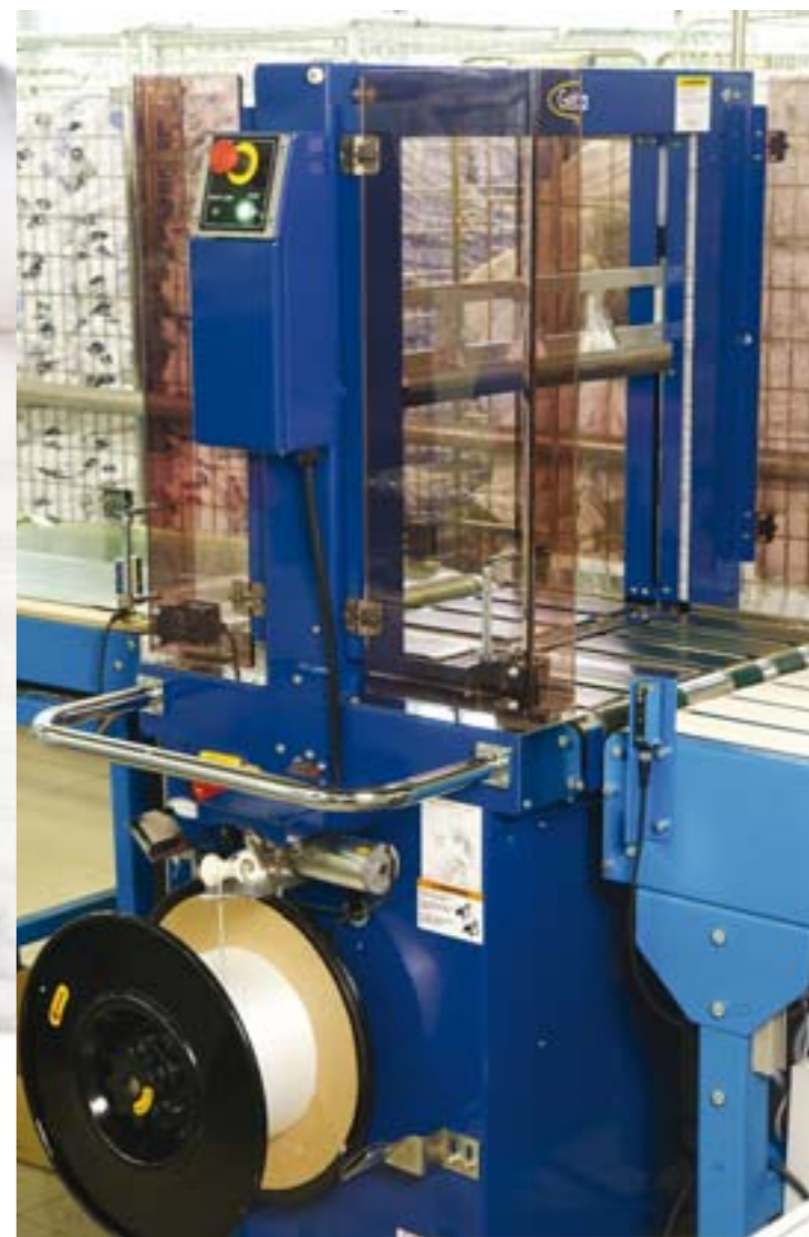
La cerceuse a été intégrée dans une ligne automatique d'alimentation et d'évacuation. La longueur du paquet à cercler est automatiquement mesurée de sorte que le cerclage soit toujours parfaitement centré.
