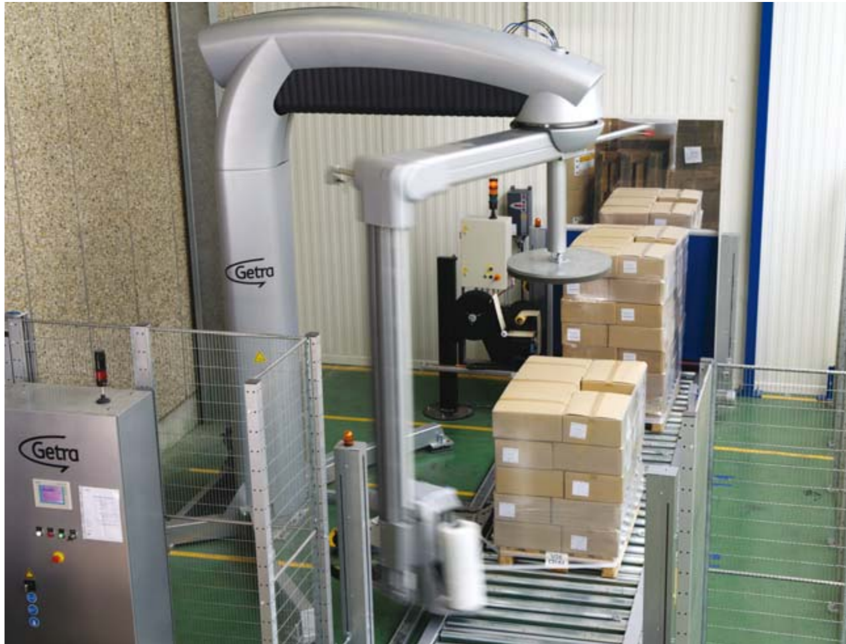
Derrière la banderoleuse se trouve un applicateur Videojet équipé d'un module d'impression en ligne Sato.
