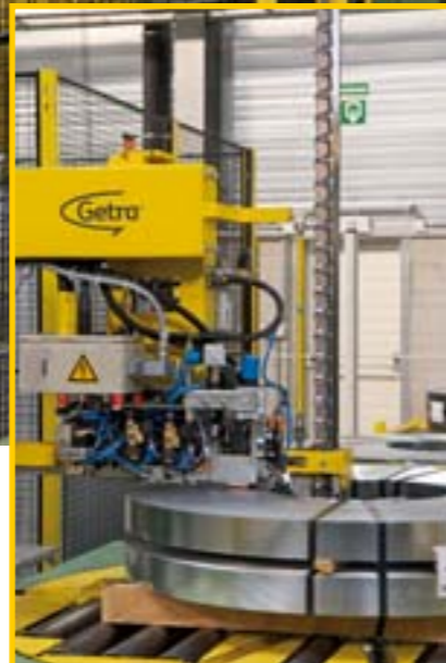
Getra - tête de cerclage Titan VS 12 avec fermeture par soudage
