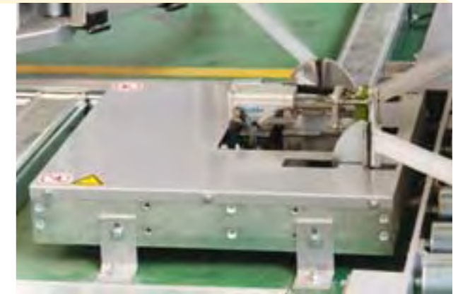
Derrière la banderoleuse se trouve un applicateur Videojet équipé d'un module d'impression en ligne Sato.
