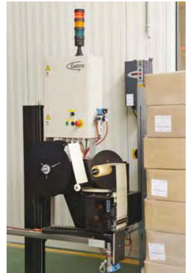
Derrière la banderoleuse se trouve un applicateur Videojet équipé d'un module d'impression en ligne Sato.
