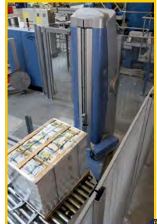
La banderoleuse est équipée d'un système de pré-étirage motorisé pour une économie optimale de film étirable.
