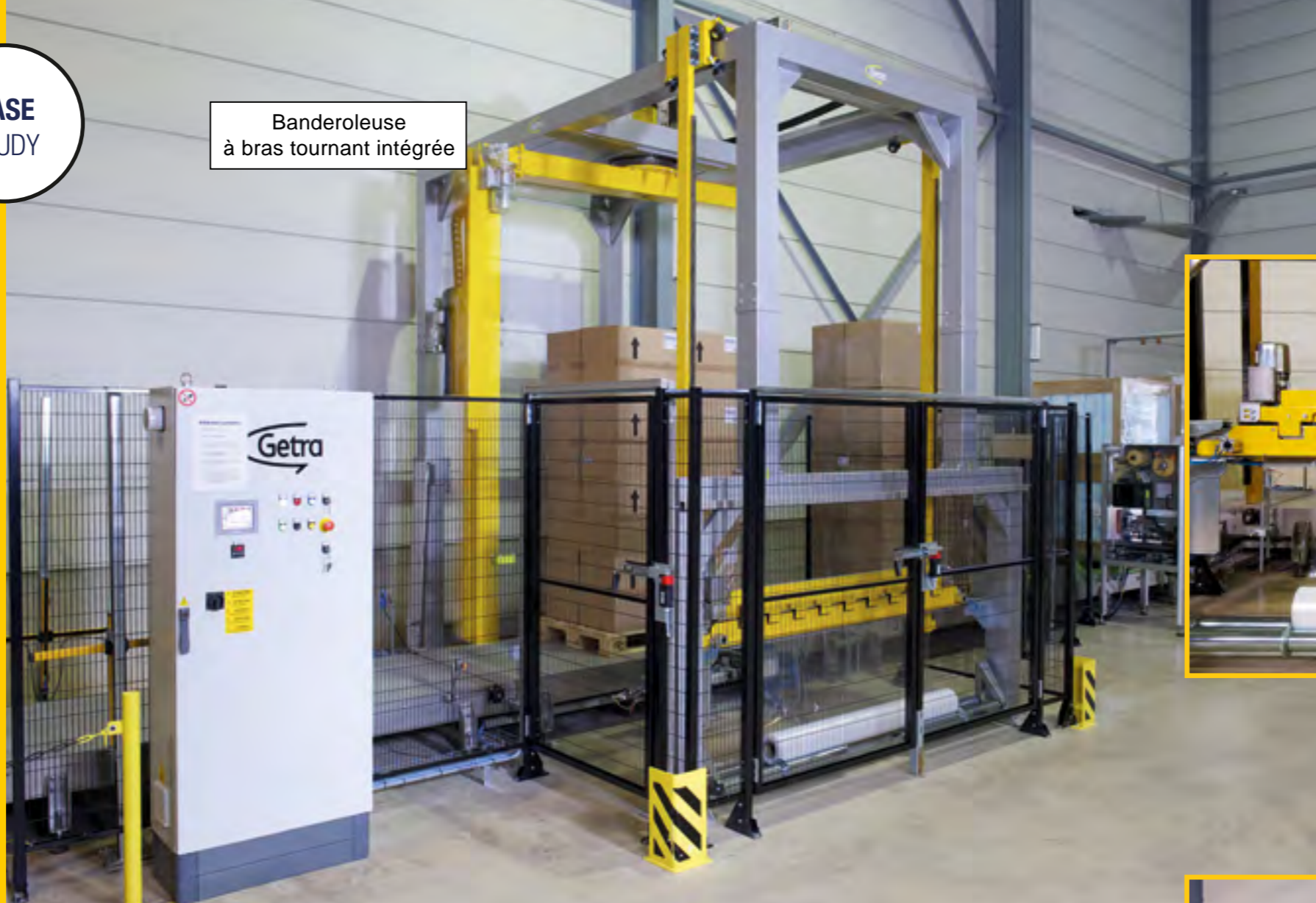
Le programme de banderolage à effectuer est transmis du logiciel de Miko Pac à la banderoleuse.
