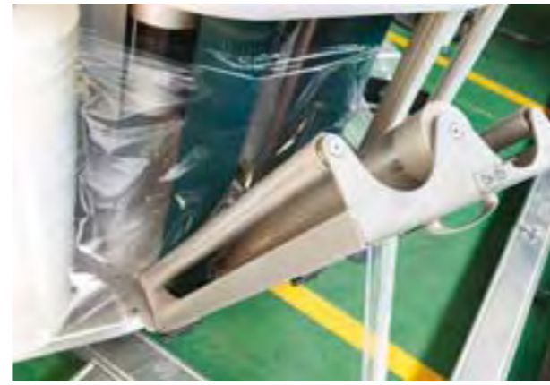
Deux rouleaux revêtus d'une couche antidérapante assurent un pré-étirage net de 150%. Le système de pré-étirage est commandé par moteur.
