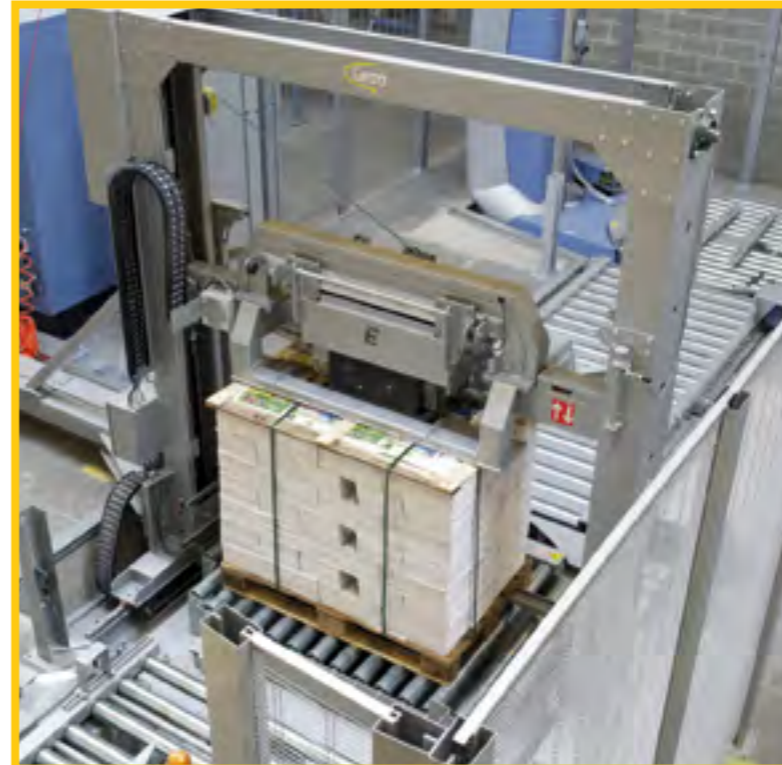
La cerceuse est équipée d'une tête de cerclage TITAN VK10. La presse serre l'ensemble avec la puissance correcte avant que le cerclage ne se fasse.
